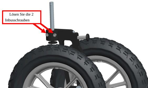
1. Lösen Sie die beiden Inbusschrauben und schieben Sie die QR-Achse durch die Gabel nach unten, bis die große Achsmutter sichtbar ist.
