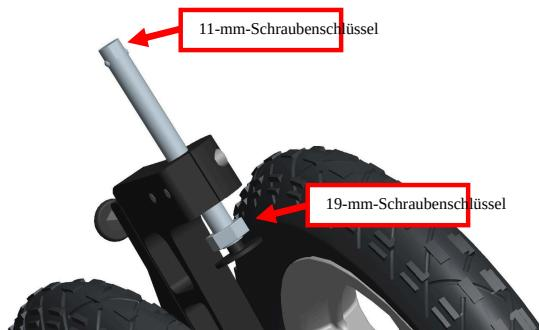
2. Passen Sie die Länge der Schnellspannachse mit einem 11-mm- und einem 19-mm-Schlüssel an. Halten Sie die Schnellspannachse mit dem 11-mm-Schlüssel am Ende fest, um ein Verdrehen zu verhindern. Stellen Sie die Mutter mit dem 19-mm-Schlüssel ein. Sollte die Achse nicht im Rahmen einrasten, genügt es, die Mutter eine  $\frac{1}{4}$ -1/2 Umdrehung gegen den Uhrzeigersinn zu drehen.
