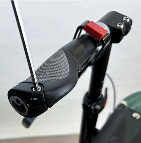
1. Lösen Sie die Schraube am hinteren Ende des Griffs mit einem 4-mm-Inbusschlüssel.
