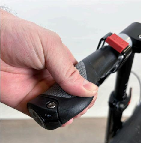
2. Drehen Sie den Griff in den gewünschten Winkel und verriegeln Sie ihn, indem Sie die Schraube wieder festziehen.
