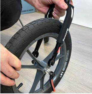
1. Führen Sie das Vorderrad in die Gabel ein, mit dem Schnellspannhebel an der Außenseite des Walkers in die Gabel ein.
