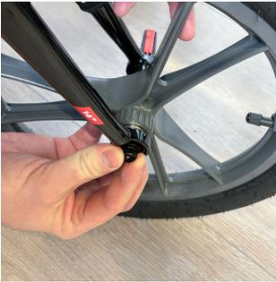
2. Ziehen Sie die Mutter auf der inneren Seite der Gabel, damit der Schnellspanner beim Schließen richtig gespannt wird.
