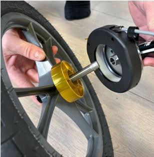
2. Um das Rad zu montieren, drücken Sie den schwarzen Knopf in der Mitte des Rads und drücken Sie die Radachse in die Achsöffnung. Lassen Sie den Knopf los, sobald das Rad die Endposition erreicht hat.
