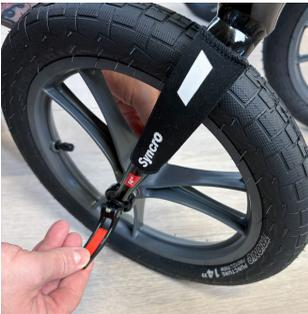
3. Schließen Sie den Schnellspanner am Vorderrad ihn entgegen der Gabel heben., indem Sie ihn nach innen klappen. Stellen Sie sicher, dass der Schnellspannhebel richtig geschlossen ist, vorzugsweise in einer Position hinter der Gabel, wenn Sie in die Fahrtrichtung des Walkers schauen.
