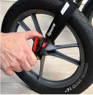
1. Öffnen Sie den Schnellspanner am Vorderrad, indem Sie ihn nach außen klappen.
