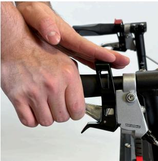
Option 3: Benutzen Sie beide Hände. Ziehen Sie den oberen roten Parkhebel mit der einen Hand nach hinten, während Sie mit der anderen den Bremshebel nach oben ziehen. Stellen Sie sicher, dass die Feststellbremse angezogen ist.
