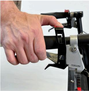
Option 2: Ziehen Sie den oberen roten Parkhebel mit Ihrem Daum nach hinten, während Sie gleichzeitig den Bremshebel nach oben ziehen. Stellen Sie sicher, dass die Feststellbremse angezogen ist, und dass der Walker sich nicht bewegt.
