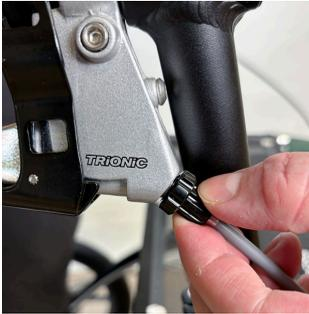
1. Wenn die Bremsen schlecht funktionieren, lösen Sie die Stellschraube an jedem Bremshebel (gegen den Uhrzeigersinn) und ziehen sie wieder fest, indem Sie die Sicherungsmutter in Richtung Hebel drehen (mit dem Uhrzeigersinn).
