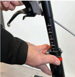
3. Sperren Sie den Handgriff in der gewählten Höhe, indem Sie den Schnellspannhebel in die geschlossene Position klappen.
